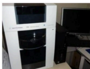
キャピラリー電気泳動装置
